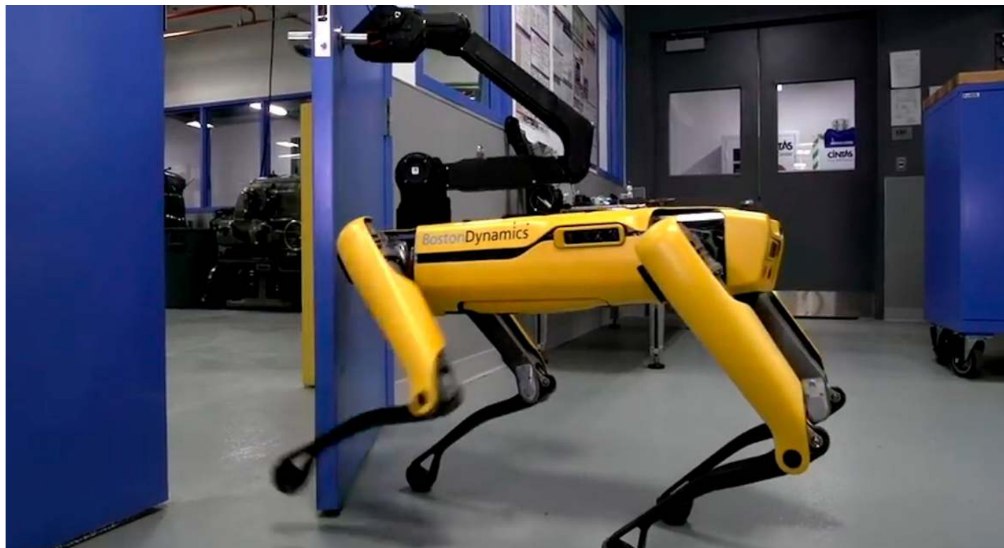
SpotMini, robot quadrupede progettato dal centro Boston Dynamics
